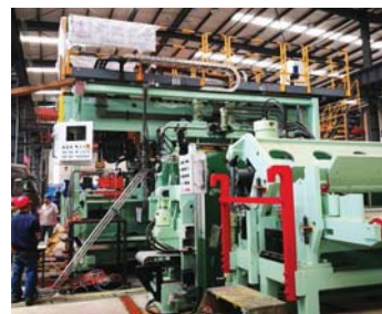
武汉凯奇研发的全球首台 GD-10C-1600 固体激光切割焊接一体机
